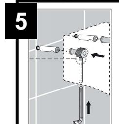
**5** Stringere (in senso antiorari) con la chiave in dotazione il grano verificando che il sanitario sia ben accostato alla parete.
