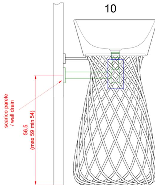
Misurare l'altezza dello scarico sul muro e posizionare il tubo di scarico alla stessa altezza
