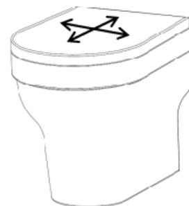
*Verificare il corretto posizionamento del cw. prima di serrare definitivamente il fissaggio.*
