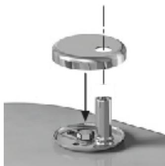
*Inserire la placchetta di copertura sul fissaggio.*
