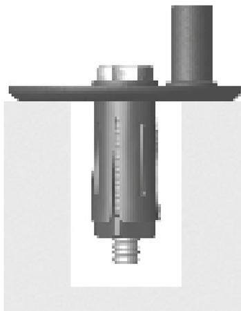
*Inserire il fissaggio nel foro del Wc.
