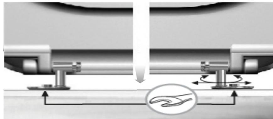
*Inserire il Cw. negli appositi fissaggi senza bloccare.*
